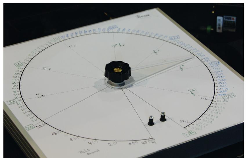
Das speziell im Freiburger *Experimentalstudio für akustische Kunst e.V.* entwickelte Steuergerät eines Sinusgenerators: eine kreisrunde Scheibe mit Eintragungen des Spielers für die 12-oktavige Frequenz-Papierscheibe, und von der Mitte der Scheibe aus ein Plexiglas-Pfeil, der mit dem Knopf in der Mitte von Hand gedreht wird.
